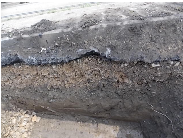
Obrázok 21 Štrk s prímiesou jemnozrnej zeminy v sonde KS-01
