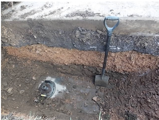
Obrázok 23 Štrk s prímiesou jemnozrnnnej zeminy v sonde KS-01
