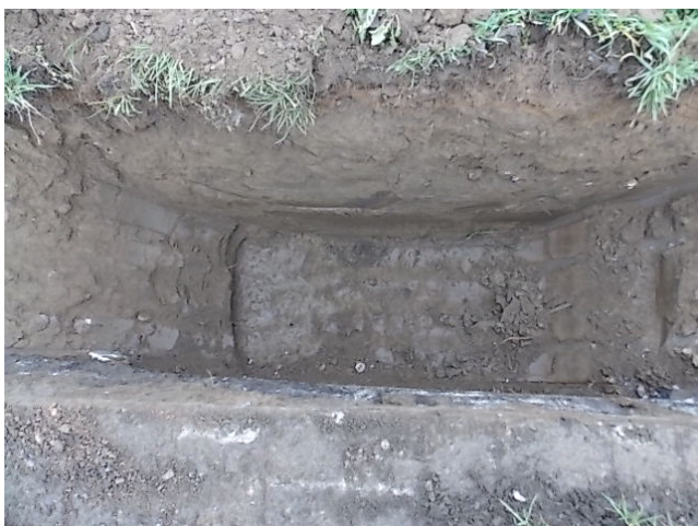
Obrázok 33 Štrk s prímiesou jemnozrnej zeminy v sonde KS-01
