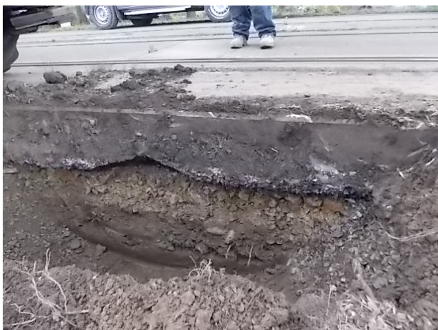
Obrázok 25 Štrk s prímiesou jemnozrnej zeminy v sonde KS-01
