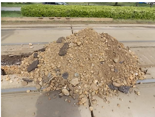
Obrázok 9 Štrk s prímiesou jemnozrnnej zeminy v sonde KS-01
