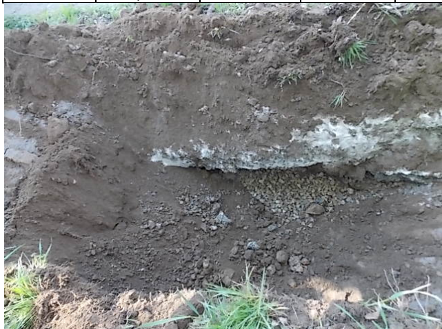
Obrázok 13 Štrk s prímiesou jemnozrnnej zeminy v sonde KS-01
