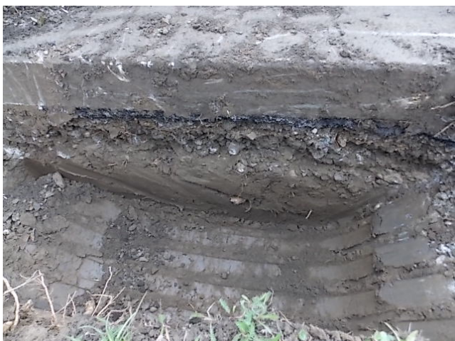
Obrázok 27 Štrk s prímiesou jemnozrnnej zeminy v sonde KS-01
