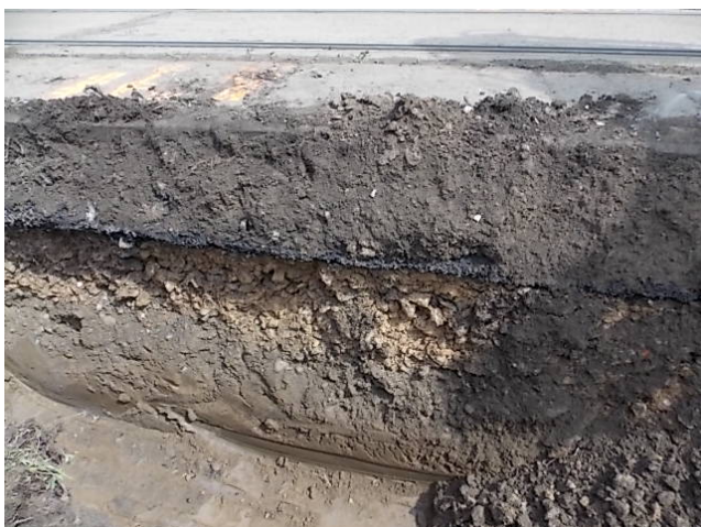
Obrázok 19 Štrk s prímiesou jemnozrnej zeminy v sonde KS-01
