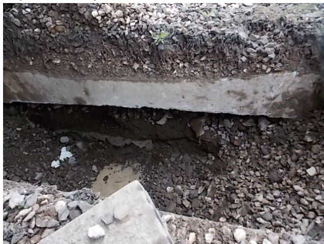
Obrázok 1 Štrk s prímiesou jemnozrnej zeminy v sonde KS-01
