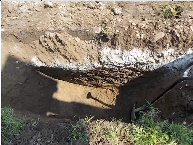
Obrázok 11 Štrk s prímiesou jemnozrnnej zeminy v sonde KS-01
