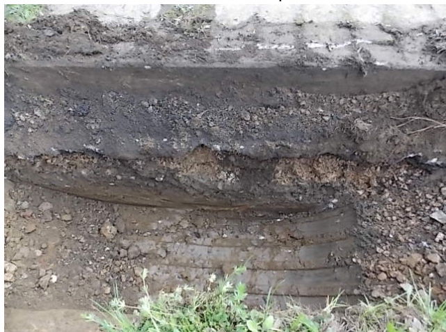
Obrázok 15 Štrk s prímiesou jemnozrnnej zeminy v sonde KS-01
