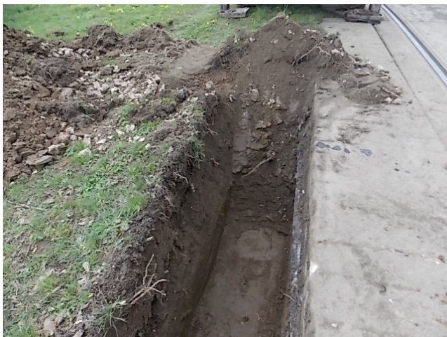
Obrázok 17 Štrk s prímiesou jemnozrnej zeminy v sonde KS-01
