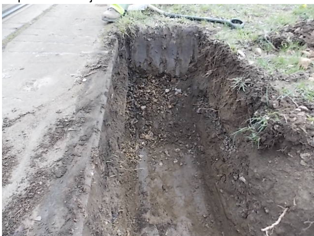
Obrázok 29 Štrk s prímiesou jemnozrnnej zeminy v sonde KS-01
